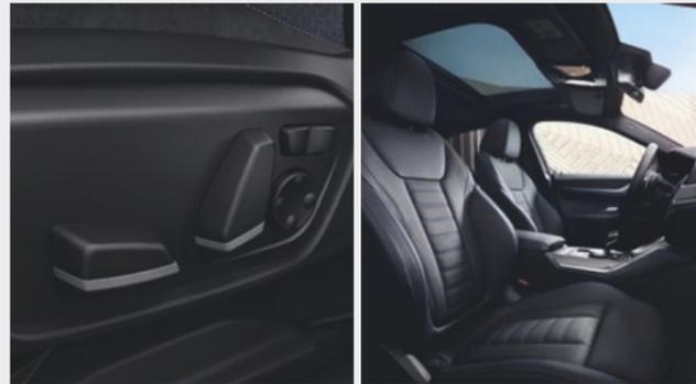
Le siège avant électrique à mémoire de forme permet le réglage électrique de la hauteur du siège, son avance, son inclinaison et celle du dossier avec mémorisation de 2 profils, y compris pour le rétroviseur extérieur conducteur. Le rétroviseur passager comprend l'aide au parking avec activation de la fonction guide-trottoir en marche arrière.
