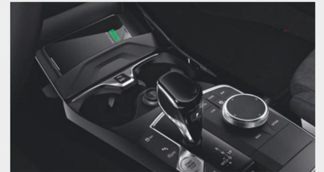
La plaque de **recharge sans fil par induction** permet de recharger le mobile sans câble et de le coupler par induction à l'antenne de toit. Peut être utilisée pour tous les appareils équipés de la technologie de recharge Qi.
