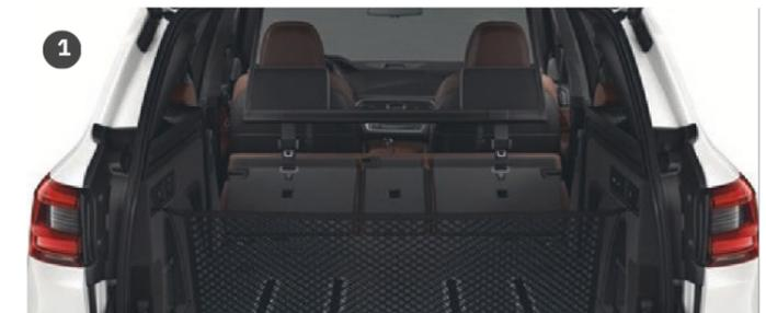
**1 - Pack Compartiment à bagages** avec filet de rangement, rails coulissants et antidérapants automatisés, un cache bagages coulissant électriquement horizontalement et verticalement.
