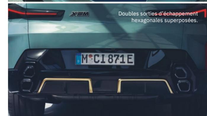
Doubles sorties d'échappement hexagonales superposées.
